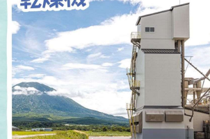
既定の水分値まで温風で乾燥させる設備
