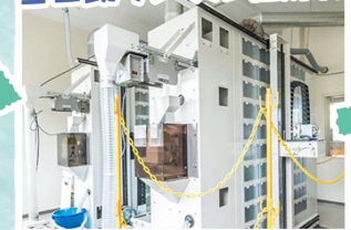
受入毎に抽出したサンプルを自動で乾燥する設備
