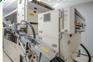
降雨や倒伏により発生する低アミノ麦を除去し、品質・等級を向上させる設備
