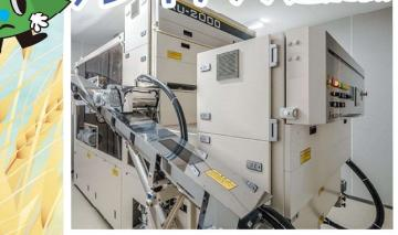
降雨や倒伏により発生する低アミロ麦を除去し、品質・等級を向上させる設備
